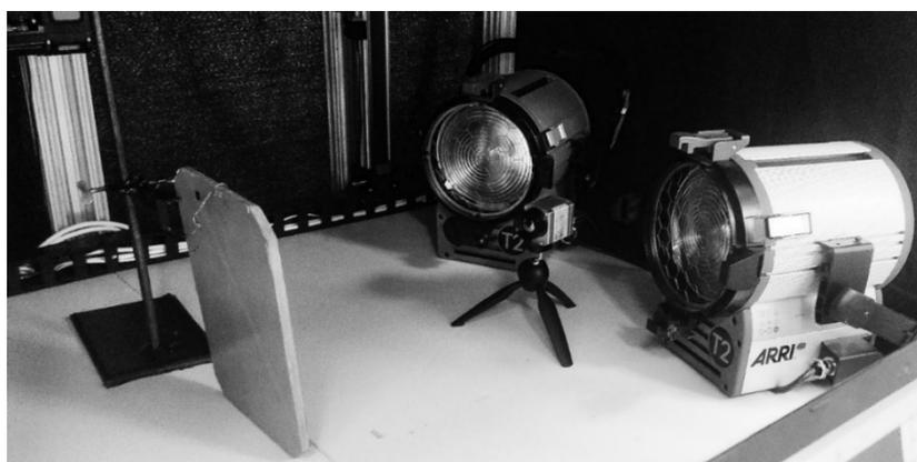
Рис. 2. Установка для тестирования режимов работы устройства управления оптическими нагревателями
