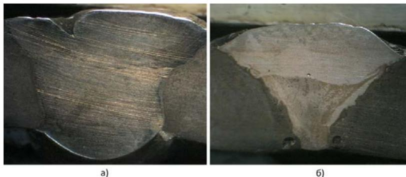
Рис. 1. Сваренные образцы: а) - ферроникелевыми электродами, б) – феррованадиевыми электродами
