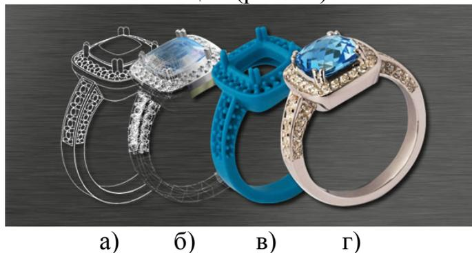
Рис. 2. Этапы проектирования и изготовления ювелирного изделия
